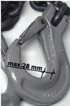
Fig. 4 Krogen i løfteøjerne, der skal fastgøres på de specielle løftebeslag, må ikke have en bredde/tværsnit på over 28 mm.
