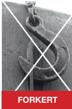
Fig. 5 Man må IKKE koble løfteøjerne på det specielle løftebeslag ved at bruge spidsen af krogen.
