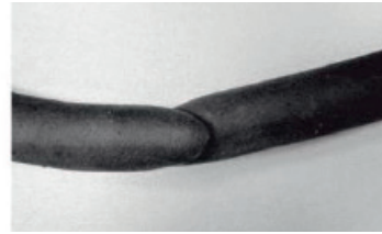
Fig. 16c Drej pakningens ender 90° og klem dem sammen.
